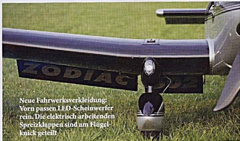
**Neue Fahrwerksverkleidung:** Vorn passen LED-Scheinwerfer rein. Die elektrisch arbeitenden Spreizklappen sind am Flügelknick geteilt
