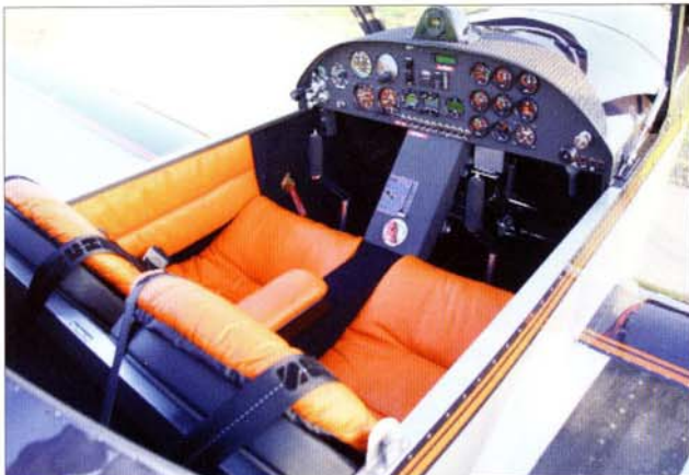
Zodiac 602 RG: Taildragger-UL mit Verstellpropeller, Einziehfahrwerk, Querruder-Trimmung und extra bequemen Sitzen.
