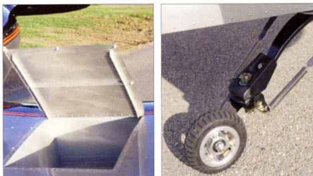
Ganzmetall-Tiefdecker mit speziellen Extras inklusive: zum Beispiel in die Flügel eingebaute Staufächer mit reichlich Platz für den großen Ausflug (Bild links) oder ein per Pedal-Impuls entkoppelbares Spornrad, das eine 360°-Drehung im Stand ermöglicht (rechts).
